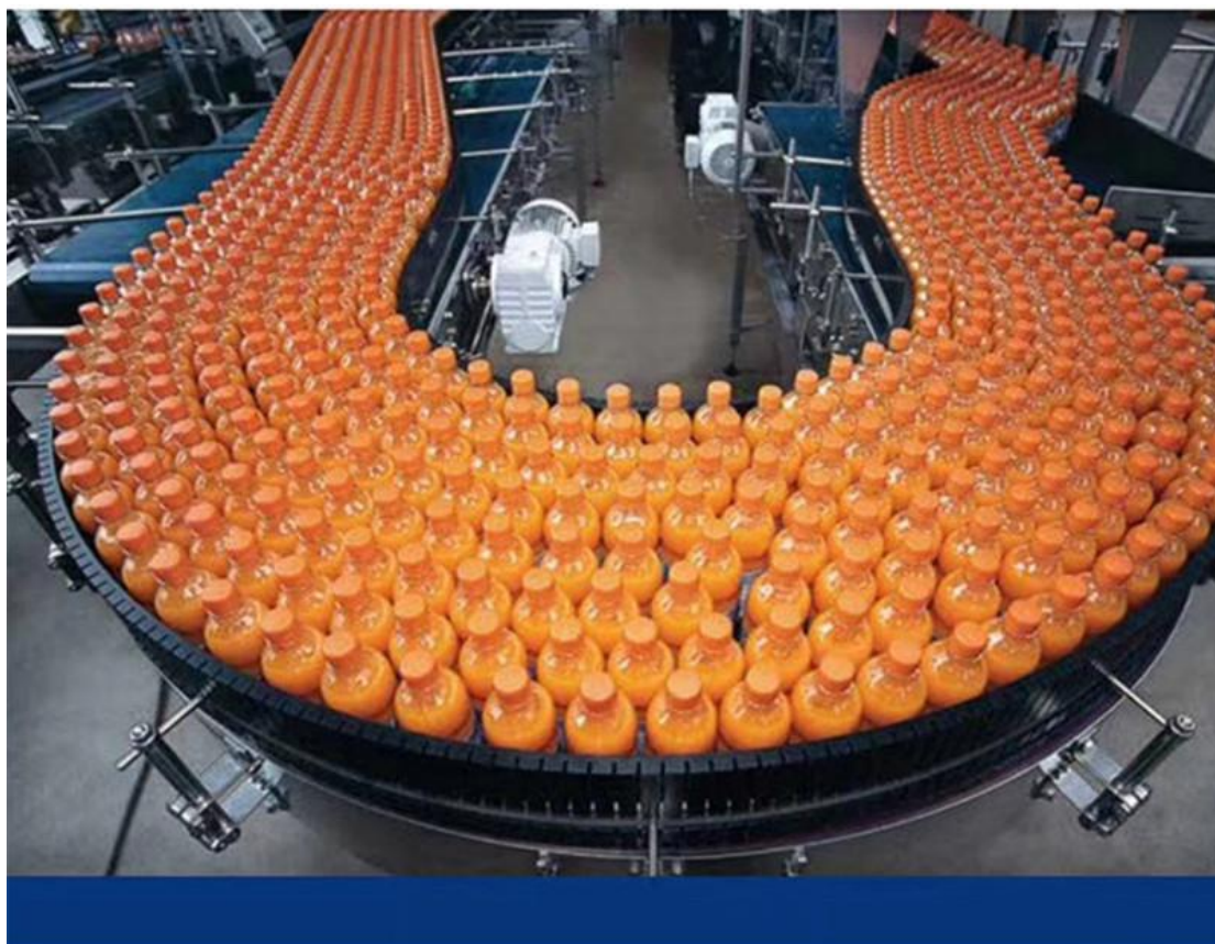
84毫米磁性转弯链板输送设计 节距25.4毫米，厚度8.7毫米
