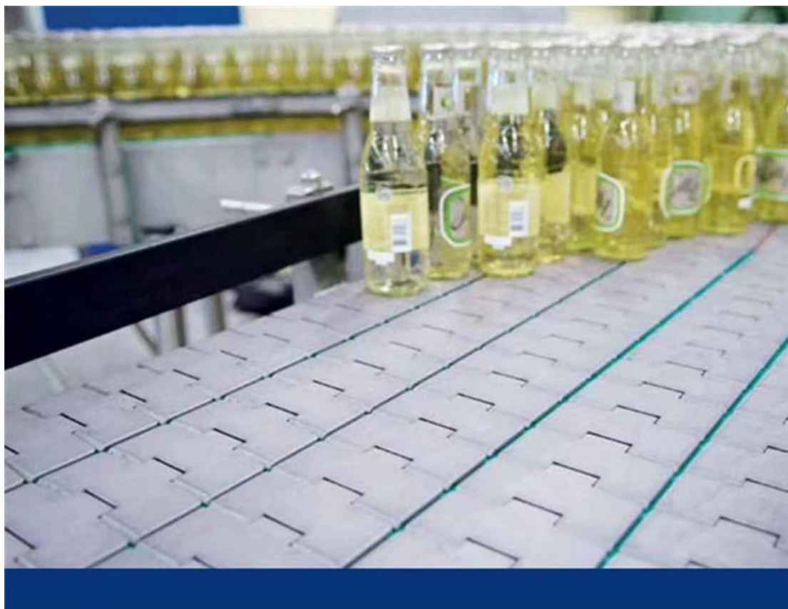
84毫米直行链板 节距38.1毫米，厚度4毫米
