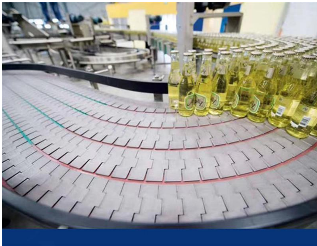
84毫米磁性转弯链板 节距38.1毫米，厚度4毫米
